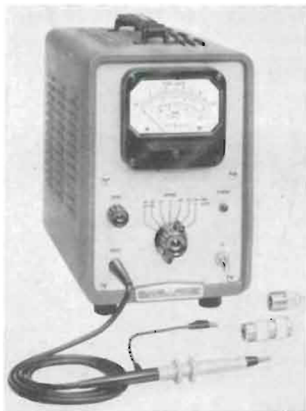
Alla Wescon Show in Los Angeles la HEWLETT-PACKARD presenta un oscilloscopio tra 10 e 1000 MHz e un voltmetro con fondo scala di 1 mV a 1000 MHz. Qui riproduciamo l'aspetto frontale del millivoltmetro, modello 411A. Tra le caratteristiche più salienti: la gamma, da 1 mV a 10 V f.s.; il campo di frequenza, fino a 1000 MHz; la scala lineare.
