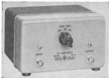
L'amplificatore 466A della -hp- fornisce un guadagno di 20 o 40 dB con risposta di frequenza entro 0,5 dB da 10 Hz a 1 MHz e punti a 2 dB a 5 Hz e a 2 MHz. È completamente transistorizzato e può essere alimentato a batterie.
