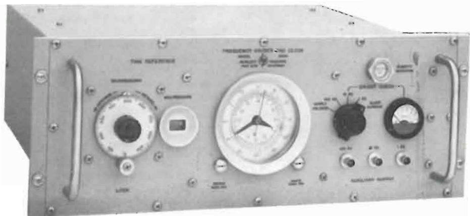
Fig. 1 - Il nuovo orologio mod 113 AR semplifica il confronto fra gli standard locali di frequenza e le trasmissioni degli standard primari ed inoltre aumenta la precisione di esecuzione di tali confronti.
