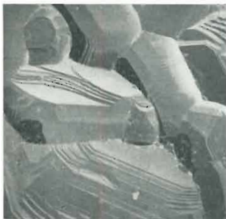
Superficie di un magnete di ferroxdure (ingrandimento = 13500 volte)
