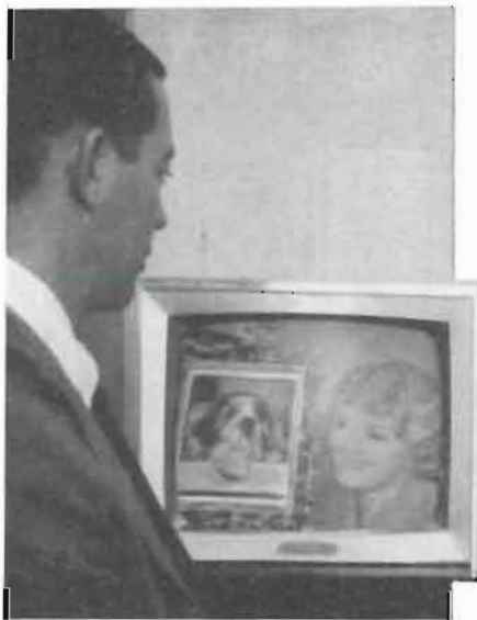
Pur senza avere aumentato sensibilmente le proprie dimensioni generali rispetto al 21", il 23" si giova di una maggior zona visiva di 129 cm 2 e presenta uno schermo più rettangolare a fronte del formato ovale dei tipi precedenti. La corazzatura del tubo 23", saldata direttamente alla faccia del cinescopio, appare notevolmente più piatta del vecchio tipo 21".
